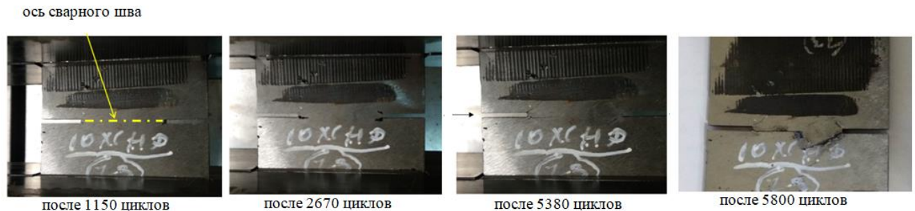
Рисунок 6.16 - Этапы разрушения образца из стали 10XCHD толщиной 5,5 мм (нагрузка 115Нм; частота нагружения 0,14 Гц)
