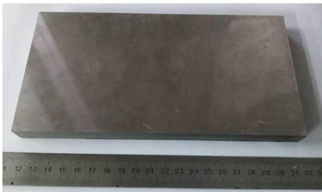
Рисунок 3.9 - Синтезированный и механически обработанный образец из 04X19Н9 для испытаний на единичные удары
