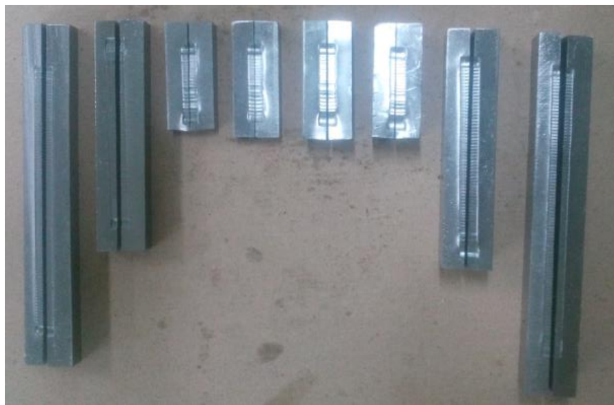
Рисунок 4.8 - Разрезанные образцы разной длины, ширины, толщины, в направлении продольной подачи инструмента ВДУ, перед измерением микротвердости
