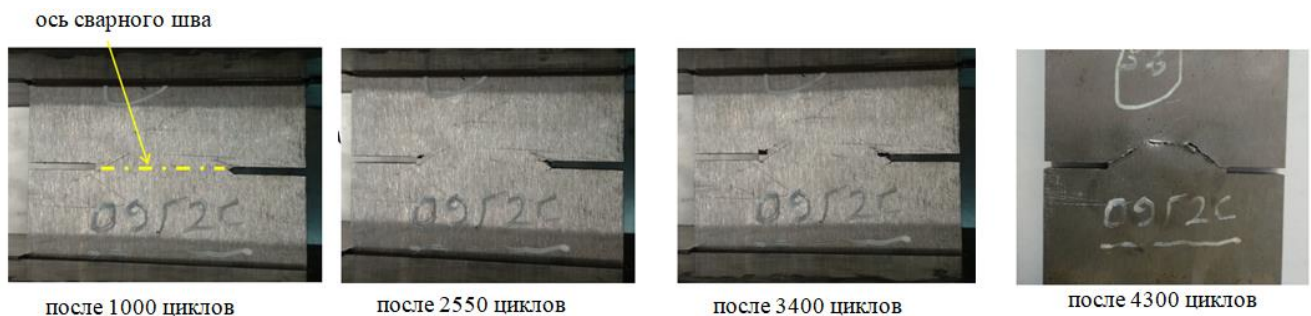
Рисунок 6.17 - Этапы разрушения образца из стали 09Г2С толщиной 9 мм (нагрузка 250 Нм; частота нагружения 0,15 Гц)
