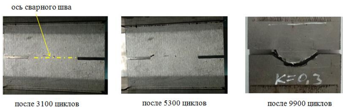
Рисунок 6.18 - Этапы разрушения образца из стали 30ХГСА толщиной 7 мм (нагрузка 190 Нм; частота нагружения 0,15 Гц)
